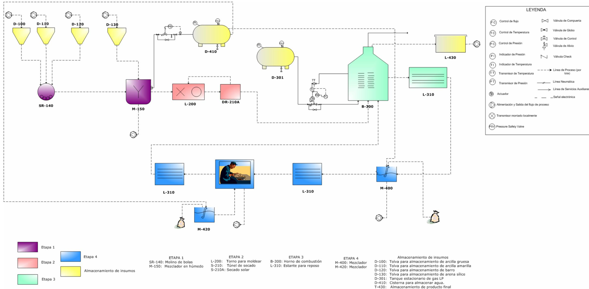
**Figura E-1. Diagrama de instrumentación y tubería del proceso artesanal de elaboración de cerámica.**
