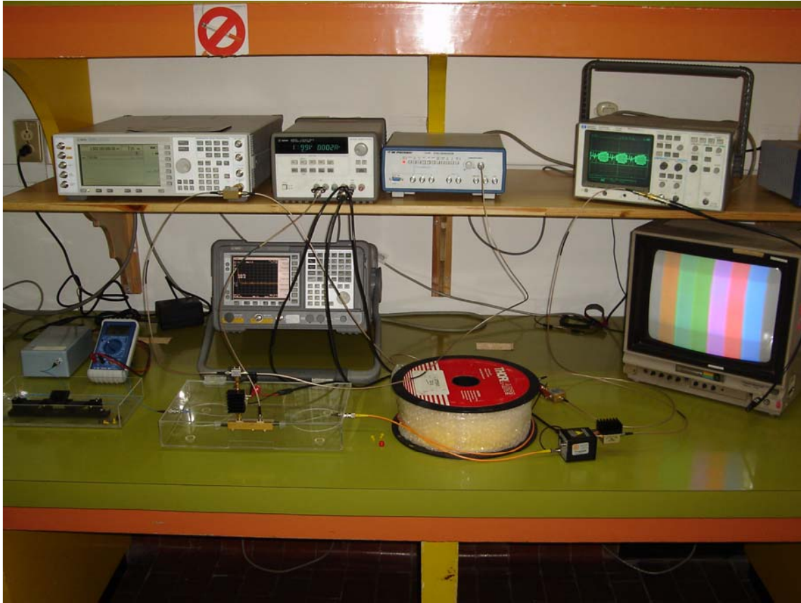
Figura 5.14 Foto de arreglo de transmisión y recuperación de señal de video.
