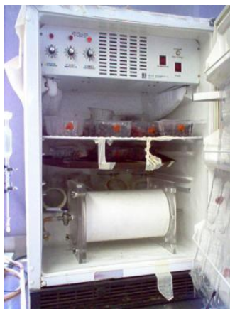
Figura 17. Cámara de temperatura y humedad relativa controladas.
