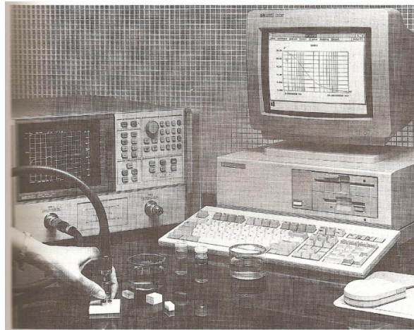
Fig. 15 Sistema de sonda coaxial para la medición de las propiedades dieléctricas de los materiales (Buffler, 1993)
