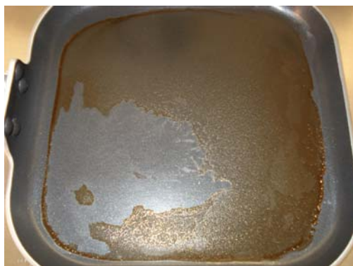
Figura 22. Película a base del extracto de nopal con plastificantes (PEG y glicerol).
