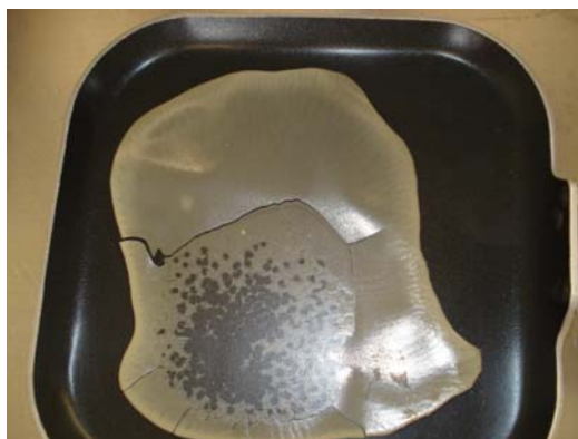
Figura 27. Película comestible a base de mucílago de nopal seco y glicerol.
