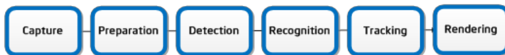
Figura 2.6 Fases presentes en la canalización de procesos en el sistema d' Fusion AR, de la empresa Total Immersion
