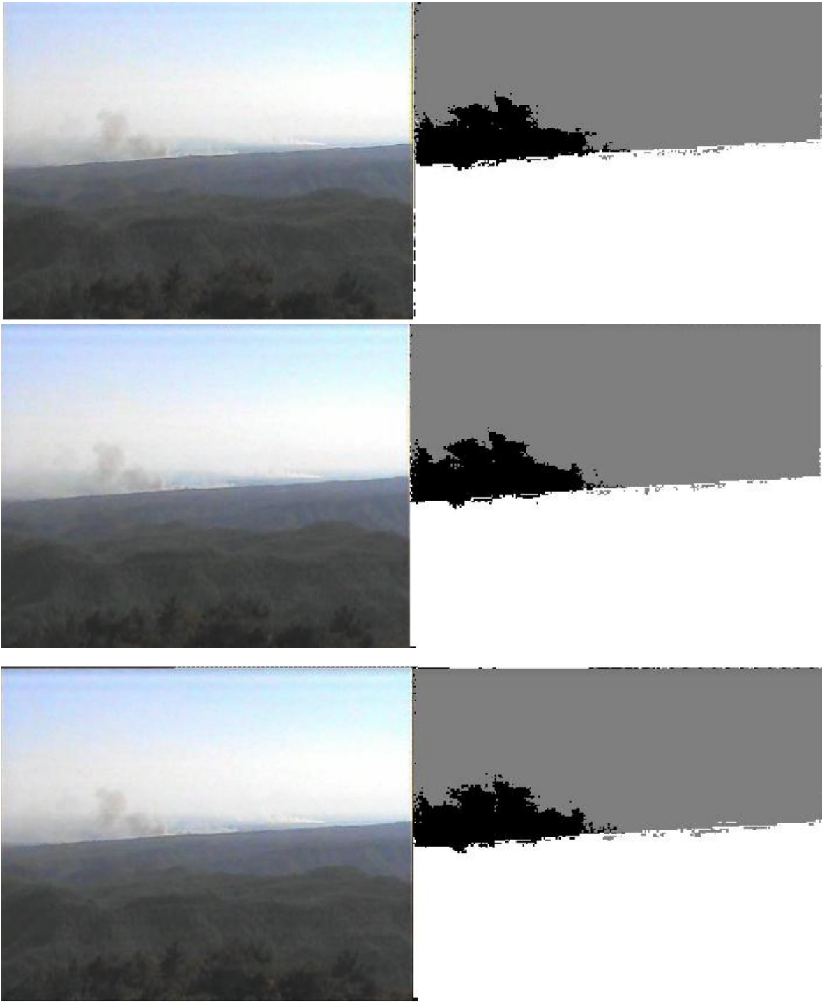
Figura 7 Detección de humo a alta iluminación
