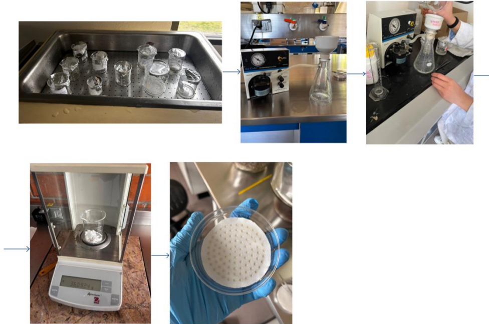
Figura 14. Proceso fase orgánica e inorgánica para obtener filtros con MP
