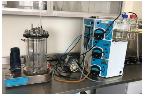
Figura 4. Reactor fotosecuencial modelo 2F-5000 empleado en el proceso de biogranulación experimental.
