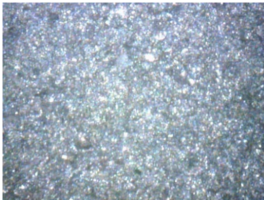
Figura A5.1. Fotografía de testigo de referencia de acero al carbón 1010
