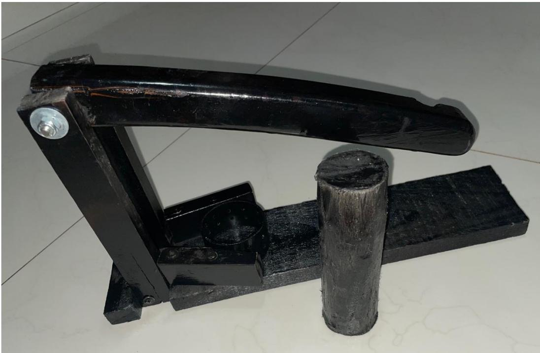
**Figura A-8.** Prensa artesanal para elaborar briquetas (Fuente: Los Autores).
