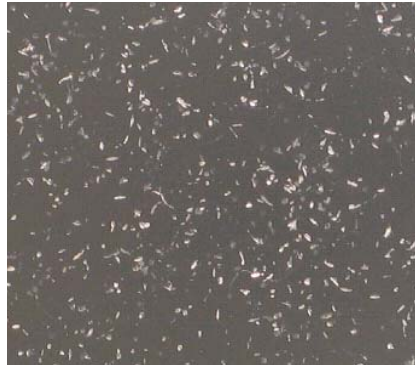
Figura 3.12 Lámina sometida a prueba de resistencia al impacto de piedras
