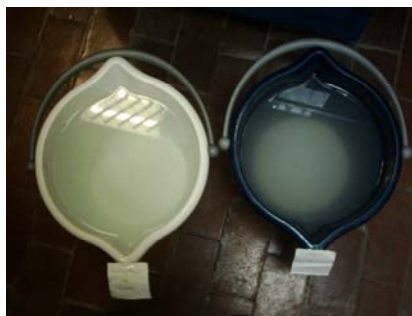
Figura 5.11 Precipitado resultante de Hidróxido de sodio con sulfato de cadmio e hidróxido de calcio con sulfato de cadmio respectivamente.
