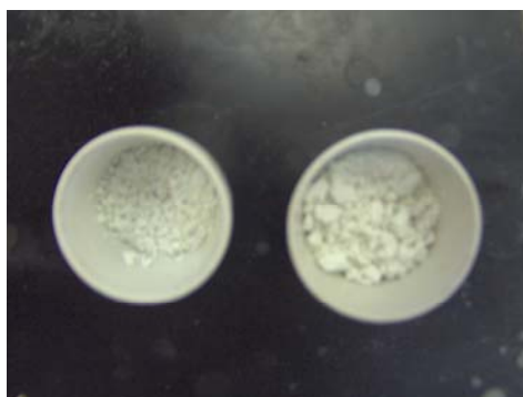
Figura 5.35 Óxidos de aluminio obtenidos después de la calcinación (lado derecho con \text{Ca}(\text{OH})_2 , lado izquierdo con \text{NaOH} )
