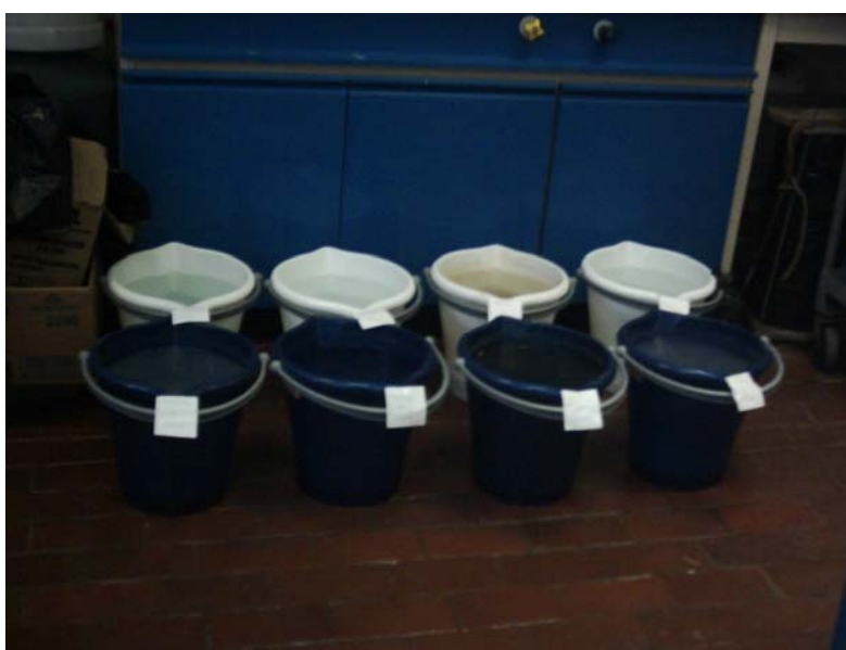
Figura 5.1 Prueba de jarras para un volumen de 10L.
