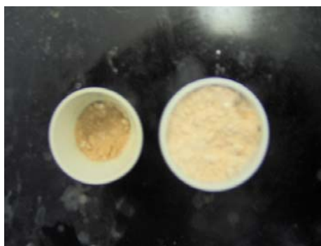
Figura 5.36 Óxidos del plomo obtenidos después de la calcinación (lado derecho con \text{Ca}(\text{OH})_2 , lado izquierdo con \text{NaOH} )
