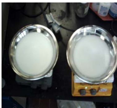
Figura 5.19 Hidróxido de cadmio secándose (lado izquierdo con NaOH y lado derecho con \text{Ca}(\text{OH})_2 )
