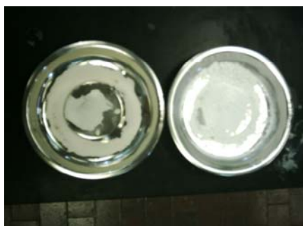
Figura 5.25 Plomo seco (lado izquierdo con NaOH y lado derecho con Ca(OH) 2 )
