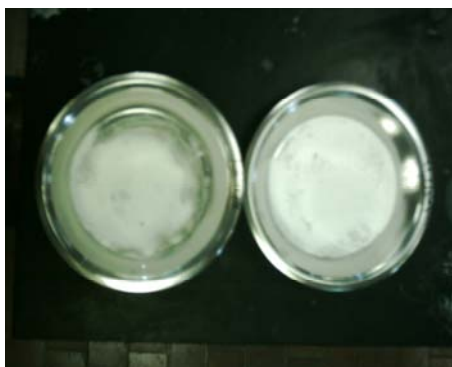
Figura 5.23 Cadmio seco (lado izquierdo con NaOH y lado derecho con Ca(OH) 2 )
