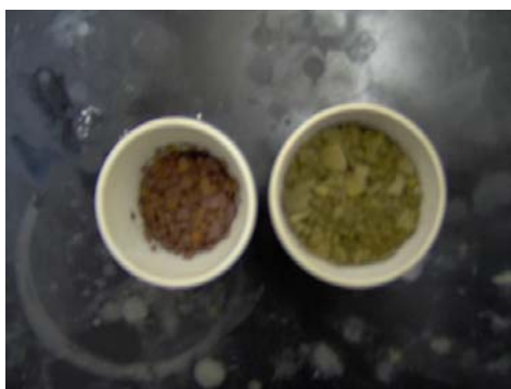
Figura 5.37 Óxidos del hierro obtenidos después de la calcinación (lado derecho con \text{Ca}(\text{OH})_2 , lado izquierdo con \text{NaOH} )
