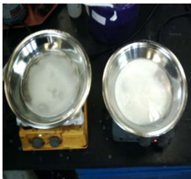
Figura 5.20 Hidróxido de aluminio secándose (lado izquierdo con \text{Ca}(\text{OH})_2 y lado derecho con NaOH)
