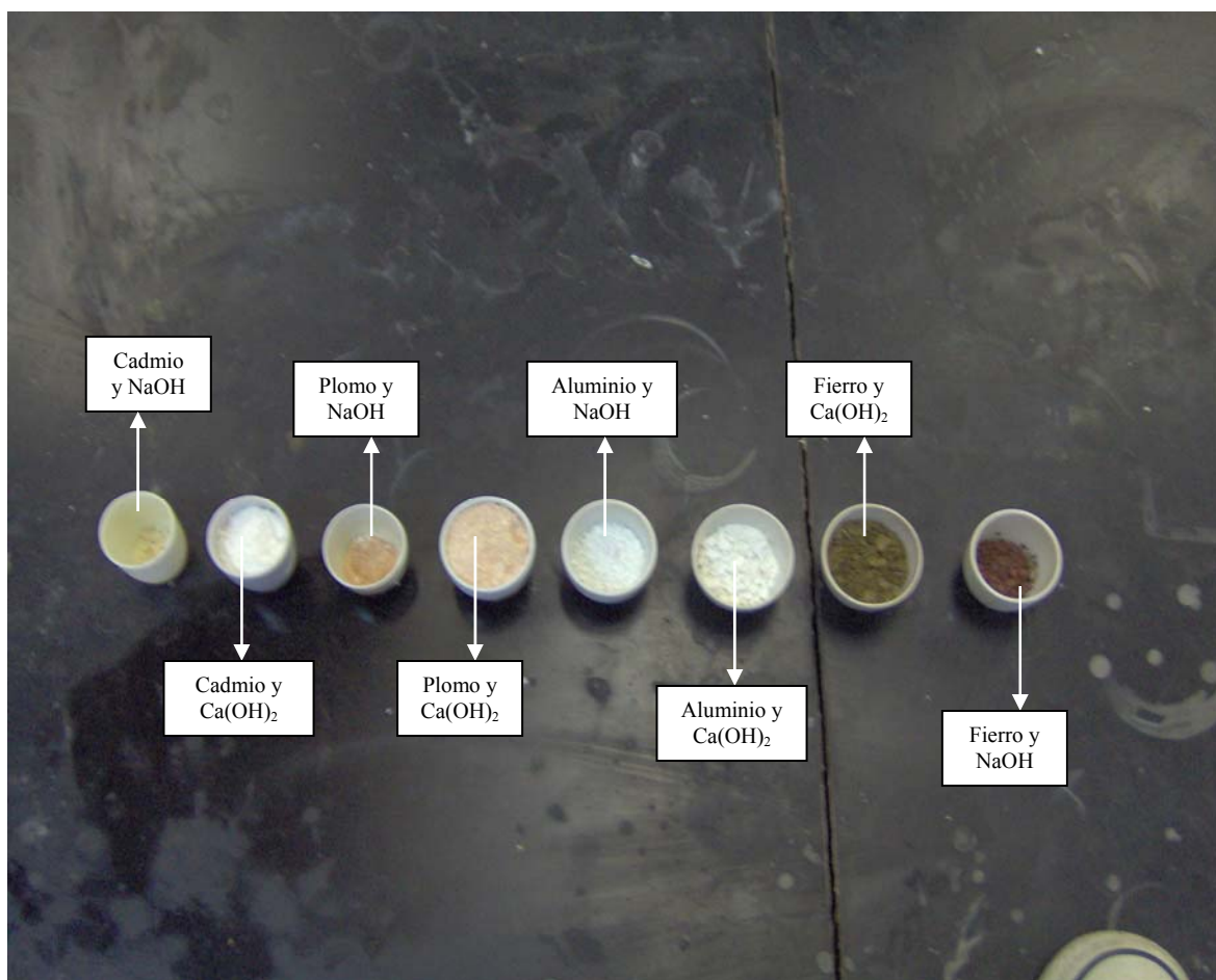
Figura 5.33 Óxidos del metal obtenidos después de la calcinación.
