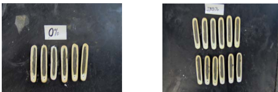
Figura 5.44 Navecillas con la mezcla de vidrio antes de colocarlas en el horno, para porcentajes de 0 y 35%
