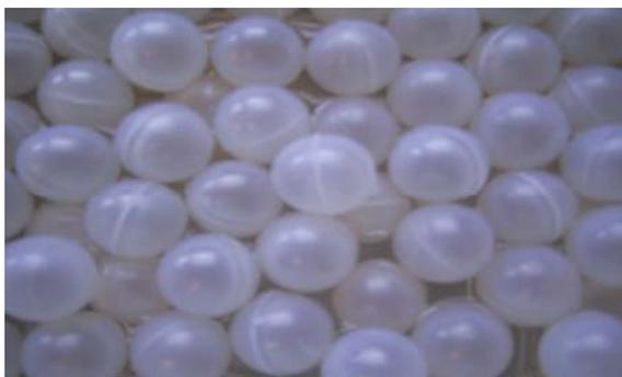
Fig. 5.5. Perlas de ebullición.
