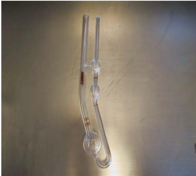
Fig. 5.8. Viscosímetro Cannon-Fenske.
