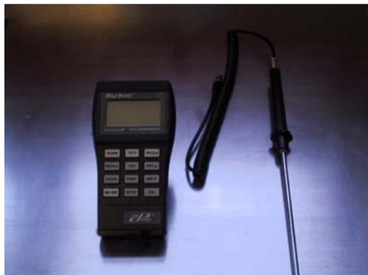
Fig.5.3. Termómetro digital de un dígito con sensor de platino.
