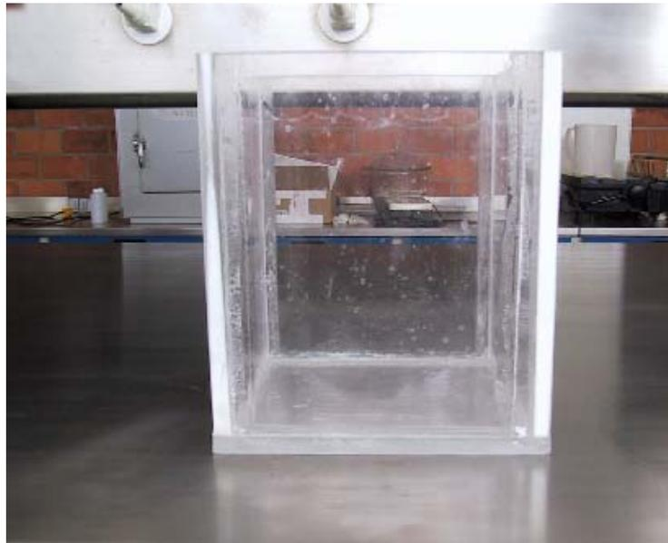
Fig. 5.7. Baño de calentamiento de 18\*20\*25 cm.
