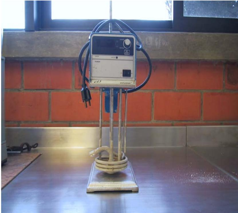
Fig.5.11. Recirculador con resistencia digital de un dígito.
