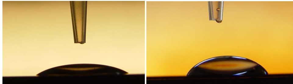
Figura5.3.3. Izq. Placa de Acero inoxidable, derecha placa de silicio (Mezcla 16%)
