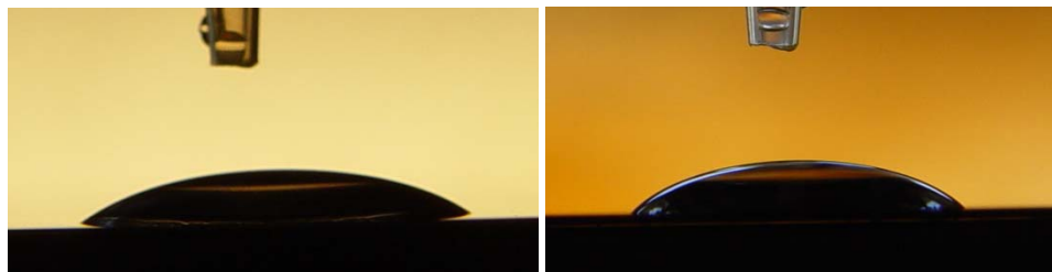
Figura 5.3.4. Izq. Placa de Acero inoxidable, derecha placa de silicio (Mezcla 24%)
