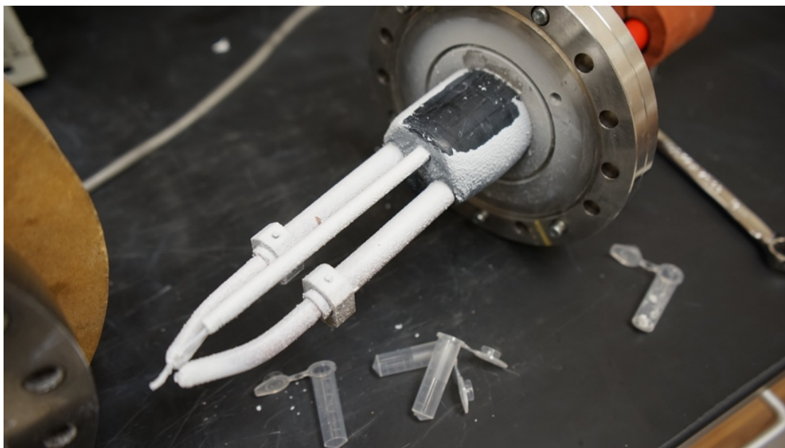
Figura 4.1 Se muestra el arreglo de descarga de arco que se encuentra en el interior de la cámara de reacción después de que se llevó a cabo la reacción. La imagen muestra tres componentes convergiendo en un solo punto: ánodo (Zn metálico), cátodo (Zn metálico), y la fuente de oxígeno.
