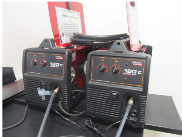
Figure 3A. Las dos soldadoras utilizadas para el sistema de descarga de arco.
