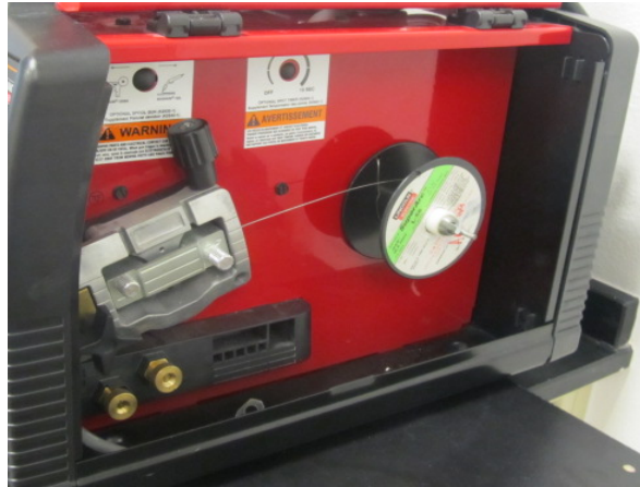
Figura 1A. Cable de Zinc montando en una de las dos soldadoras utilizadas.
