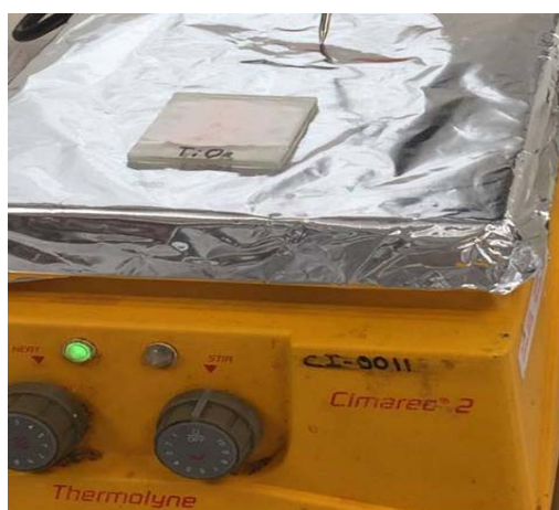
Fig 4.6 Deposición del nano material de dióxido de titanio por calor utilizando una parrilla.
