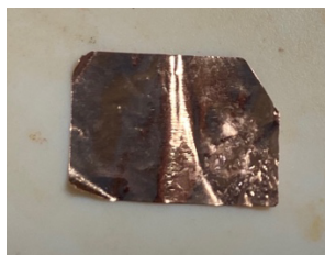
Fig. 23 Fotografía de la lámina de cobre con grafeno GCu2 al ser oxidada con una parrilla.
