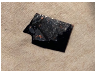
Fig. 25 Fotografía de la película de grafeno recubierta con PMMA GCu8 sobre un sustrato de Si, observable en la zona opaca. Se observa la presencia de zonas con cobre.
