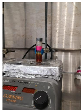
Figura 10. Sistema bifásico de hexano y agua después de la agitación.
