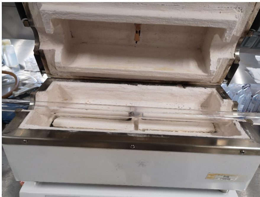
Figura 8. Horno y tubo utilizado después del calentamiento, se puede observar la placa de alúmina con los restos carbonizados de la muestra en el centro del tubo.
