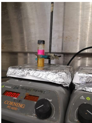
Figura 11. Sistema formado por agua y hexano para la polimerización de benceno a base de \text{Fe}^{2+} .
