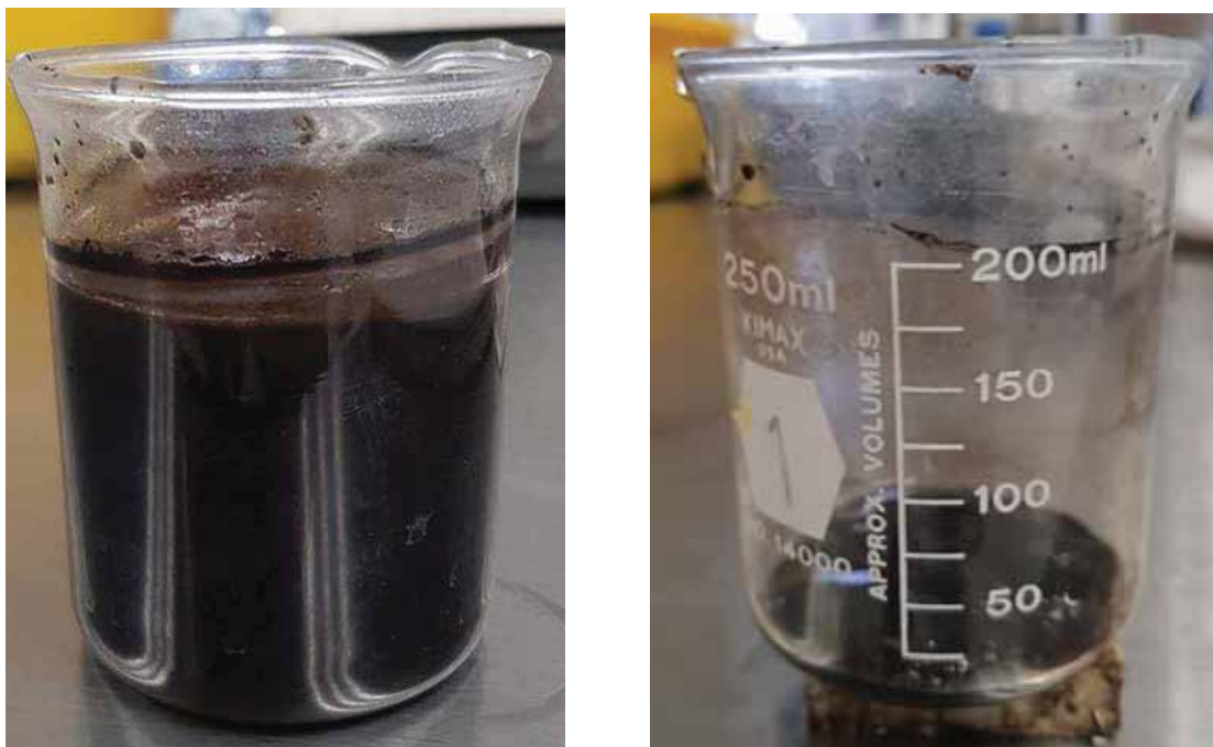
Figura 7: Decantación del excedente por método de precipitación magnética utilizando un imán de neodimio
