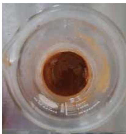
Figura 10: \text{Fe}_3\text{O}_4 @curcumina recuperado por método de precipitación magnética
