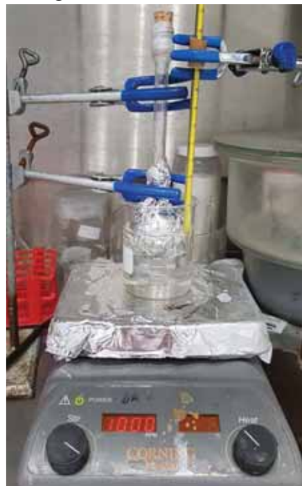
Figura 9: Sistema para síntesis de \text{Fe}_3\text{O}_4@ curcumina
