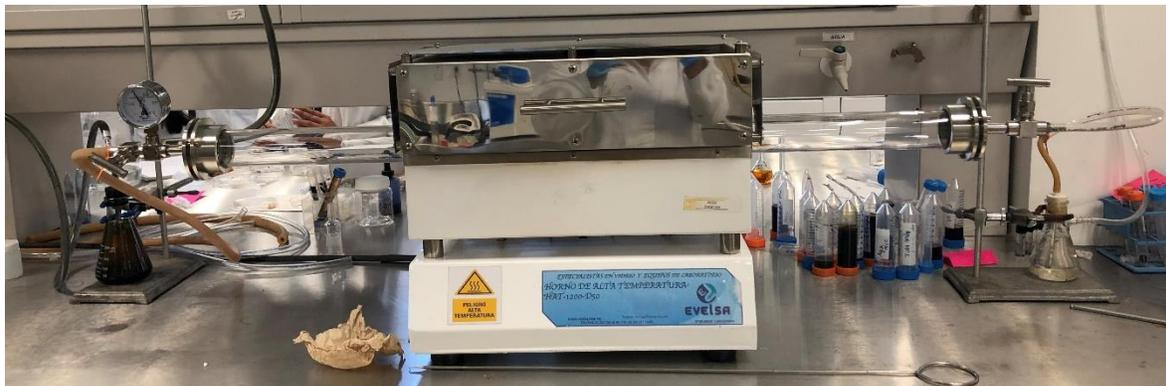
*Figura 15: Equipo de APCVD utilizado en el laboratorio de investigación de la UDLAP.*
