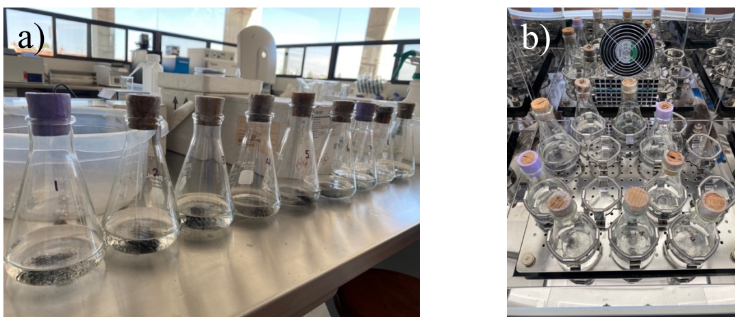
Figura 8. Preparación del pH PZC: soluciones a) iniciales y b) dentro del shaker después de 24 horas de agitación. Fuente propia.
