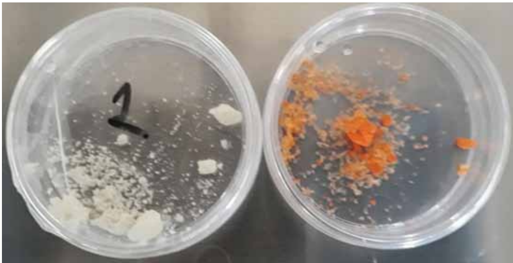
Figura 18 Formación de perovskitas a) \text{MAPbCl}_3 b) \text{MAPbBr}_3
