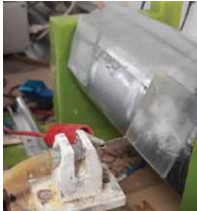
Figura 24 Proceso de deposición de NF de \text{TiO}_2 -Pb mediante uso de electrospinning
