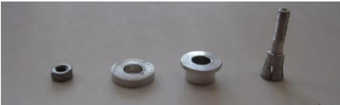
Figura 5.6 Spinner maquinado a la medida.
