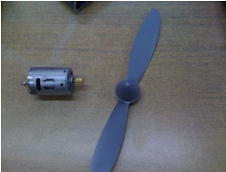
Figura 4.3: Motor de DC y Hélice para prototipo 2.
