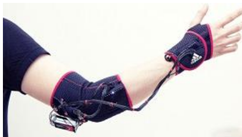
Figura 3.4 Guante inteligente de entrenamiento para atletas ciegos [41].
