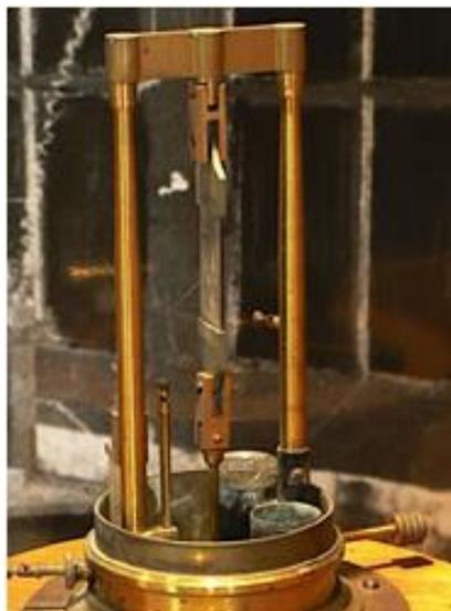
Figura 3.2.1. Prensa mecánica para medición de fenómeno piezoeléctrico en cuarzo (Gómez, s. f.).
