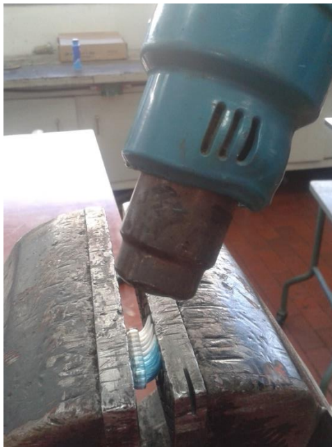
Fig. 95. Aplicación de calor
