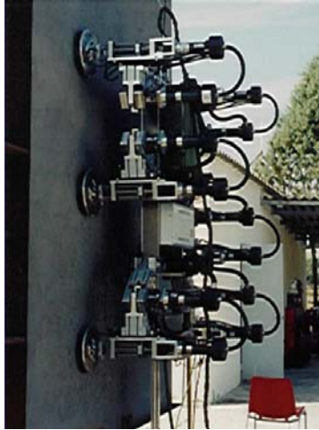
Figura 3.2 REST probado sobre una superficie ferromagnética
