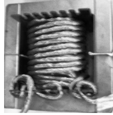
Figura 7.1. -Inductor de 900 \mu H implementado en la primera etapa elevadora
