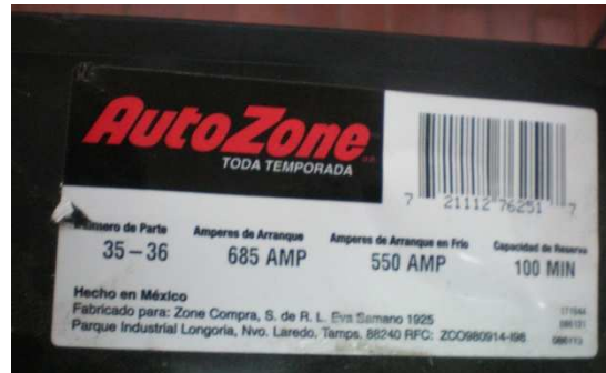
Figura A.2.- Características del acumulador de energía
