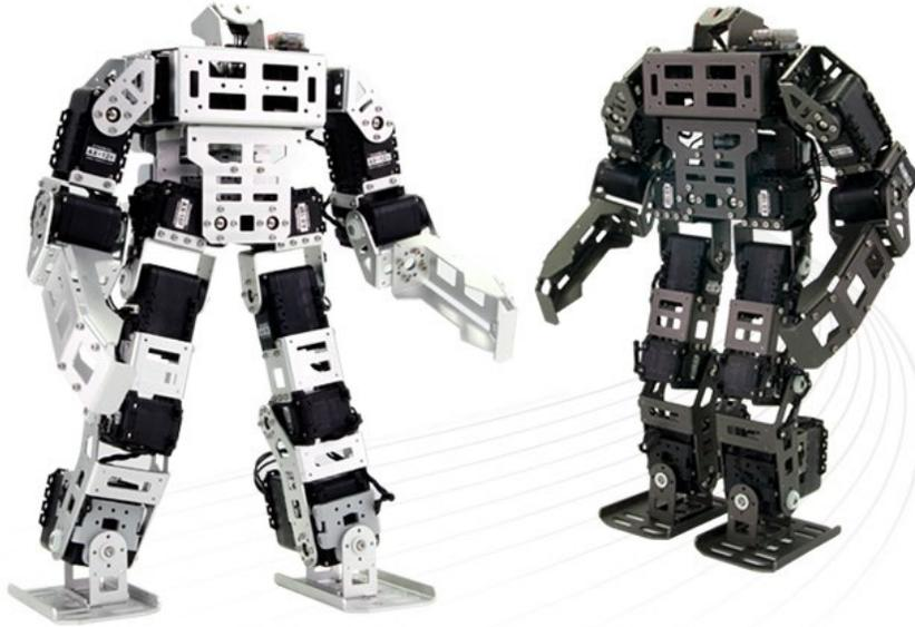
Figura 1.5. Robot Bioloid GP.
