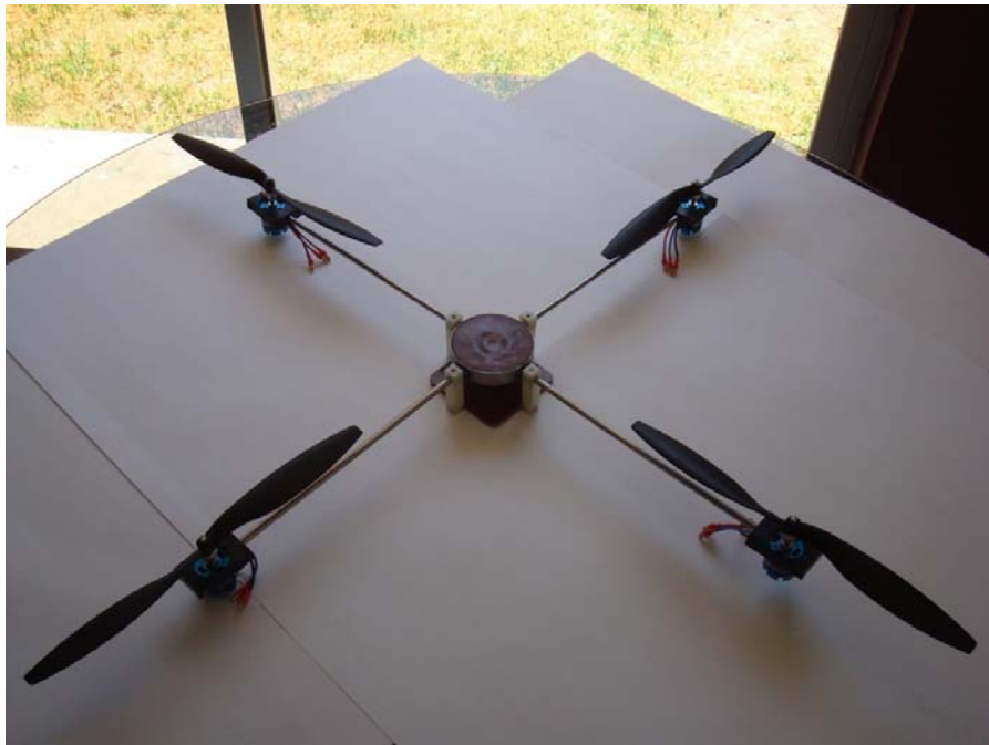
Figura 5. 6: Estructura 2 con motores y hélices.
