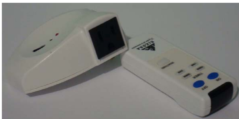
Figura 3. 3: Sistema de encendido y apagado por control remoto
