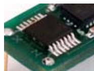
Figura 2. 12: un acelerómetro comercial montado en placa superficial.
