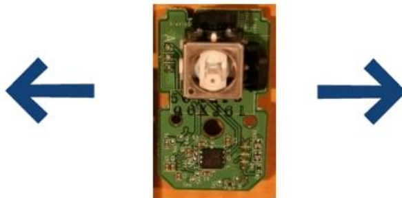
Figura 2. 16: Inclinación del eje X del acelerómetro.
