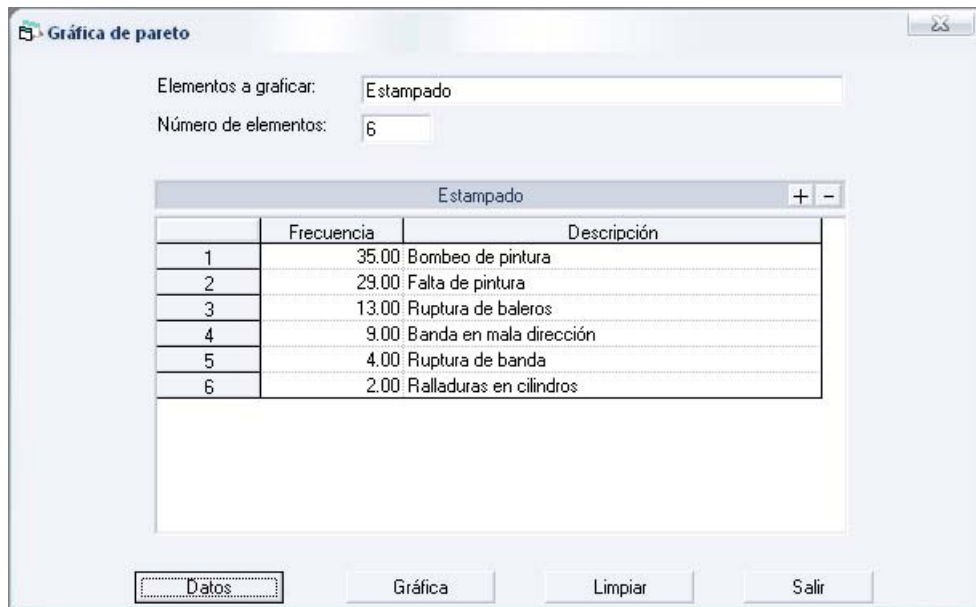
Figura 4.2.1.3 Frecuencias de fallas máquina de estampado.
