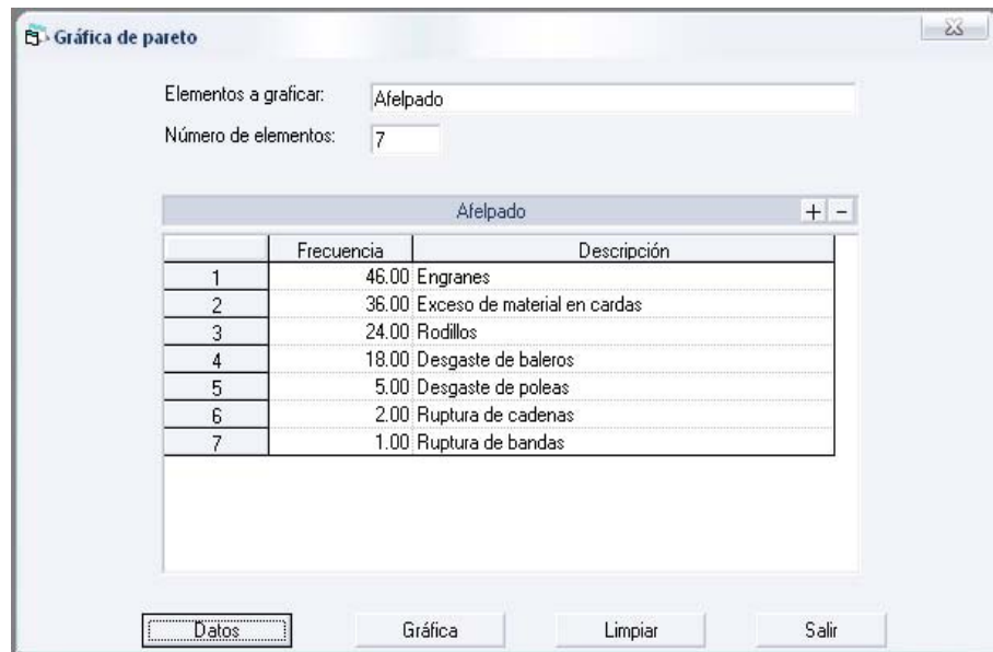
Figura 4.2.1.1 Frecuencias de fallas en máquina de afelpado.
