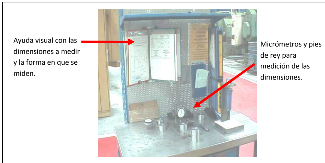
Figura 7.1: Ejemplo de puesto de autocontrol.
