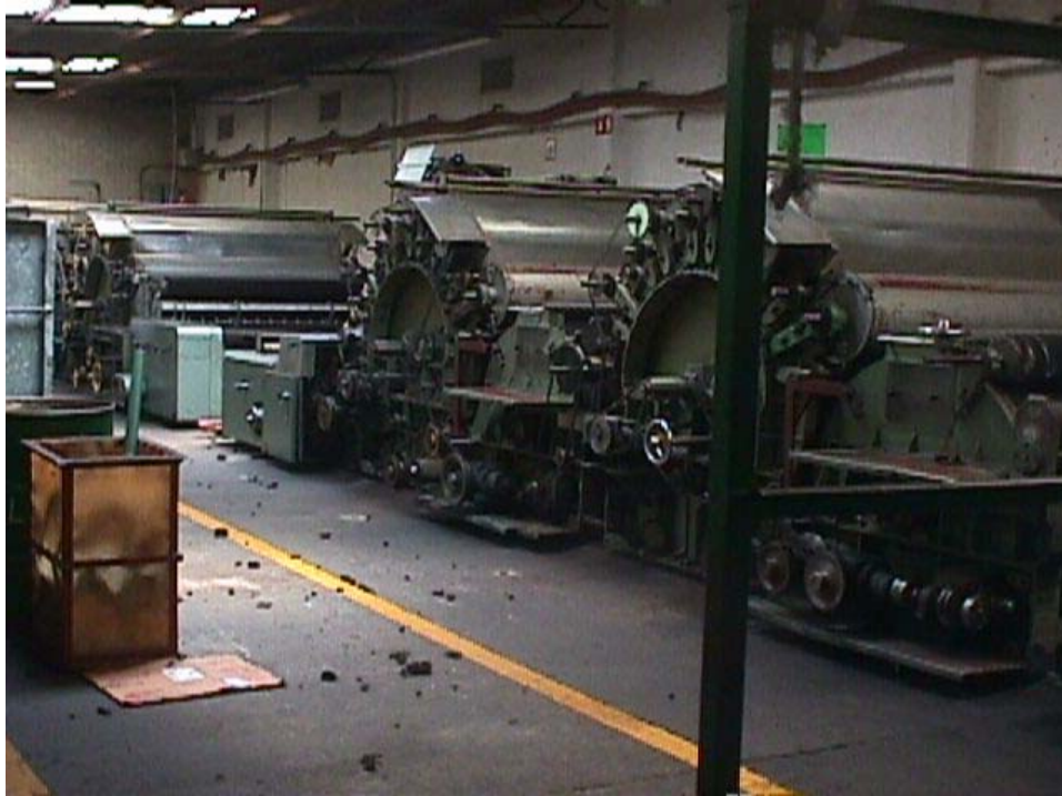
Figura 2.2.2 Los pabilos obtenidos del proceso de cardado se recogen en quesos sobre un bastidor
