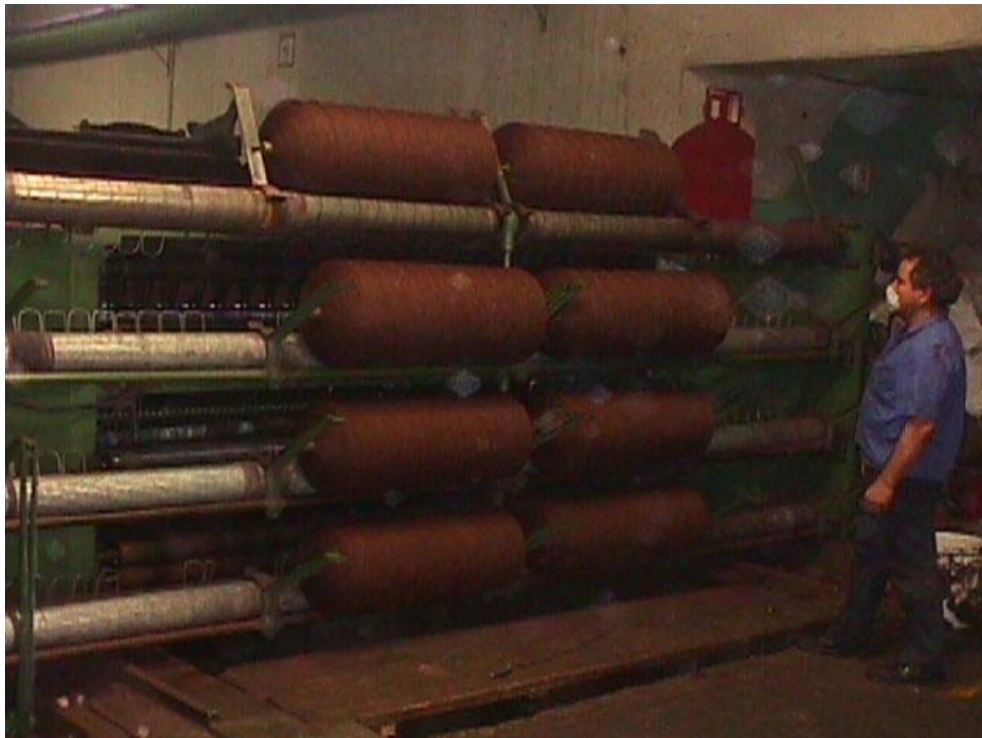
Figura 2.2.2 Los pabilos obtenidos del proceso de cardado se recogen en quesos sobre un bastidor
