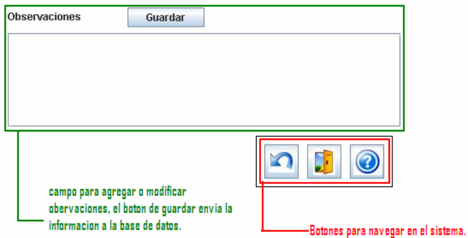
Fig.4.2.2 Parte inferior de la ventana agregar mecánico
