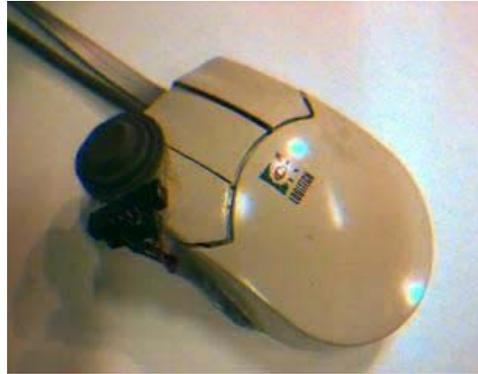
**Figura 3.3 *Sentic Mouse* Dispositivo de presión**
