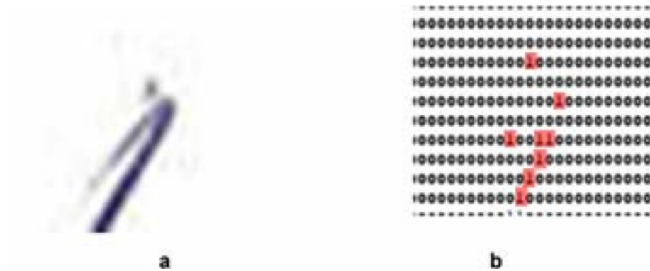
Figura 4.4 Imagen con píxeles perdidos a). Pedazo de la firma (figura 4.2). b). Matriz binaria de la imagen.
