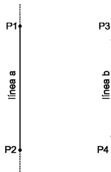
Fig A.4.- Líneas paralelas no coincidentes.
