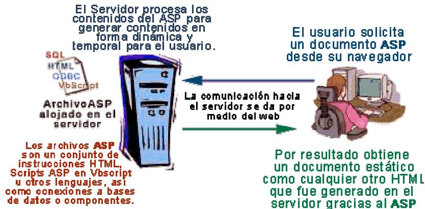
Figura 3.2 Funcionamiento de un ASP
