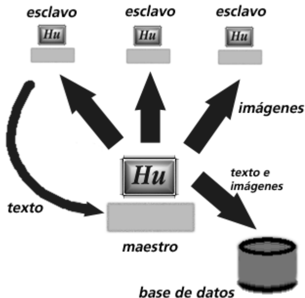
Figura 4.1: El HuProcessor, distribuye imágenes a los esclavos, y a su vez recolecta los resultados que éstos producen.
