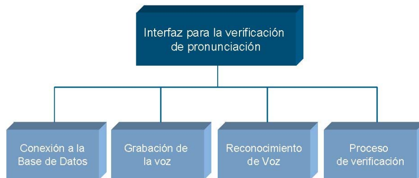
Figura 3.1 Módulos con los que interactua la interfaz para la verificación de pronunciación
