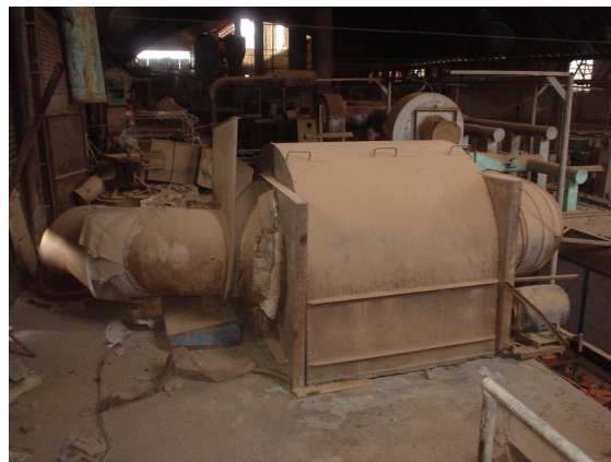
Figura 3.4.- Ventiladores que mueven el aire dentro del secador.
