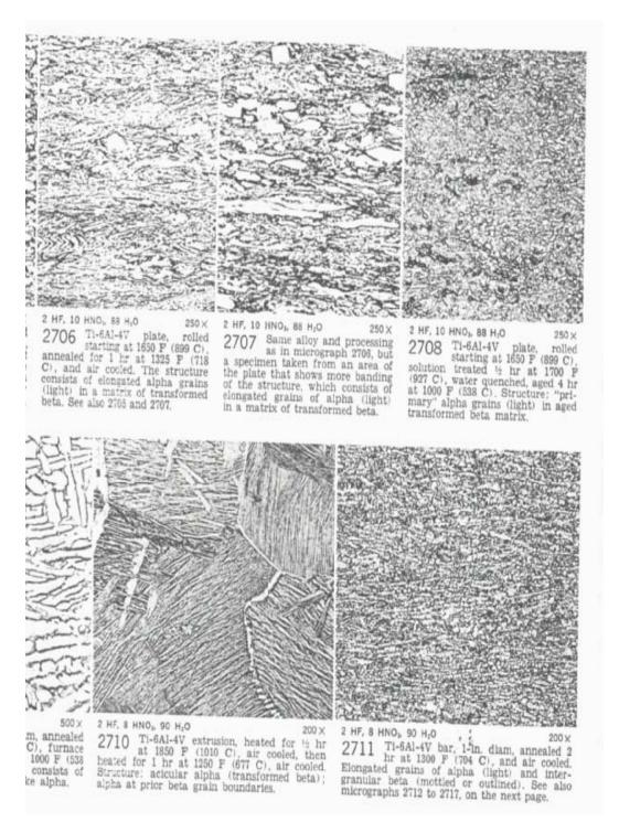
Observamos una serie de metalografías realizadas a la aleación de Ti-6Al-4V, con la única diferencia de que cada una de las aleaciones proviene de un tratamiento térmico diferente.
