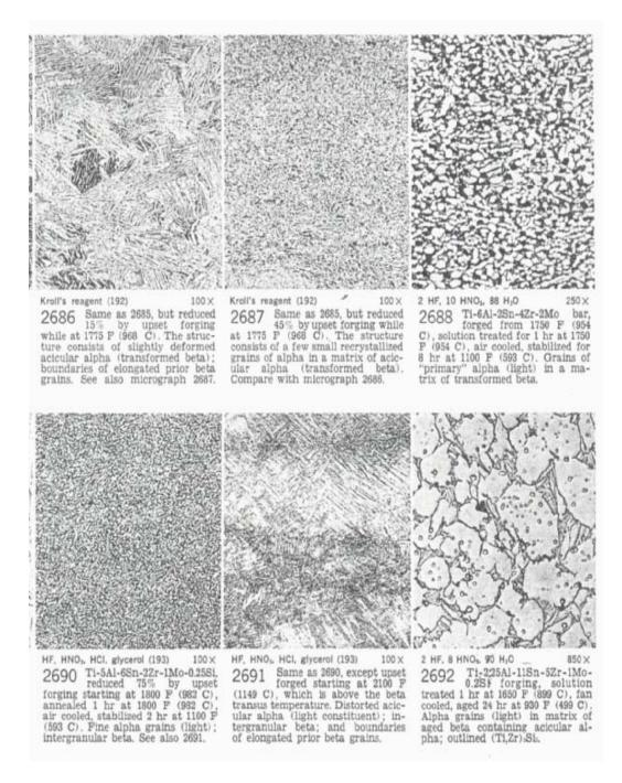
Observamos una serie de metalografías realizadas a la aleación de Ti-6Al-4V, con la única diferencia de que cada una de las aleaciones proviene de un tratamiento térmico diferente.
