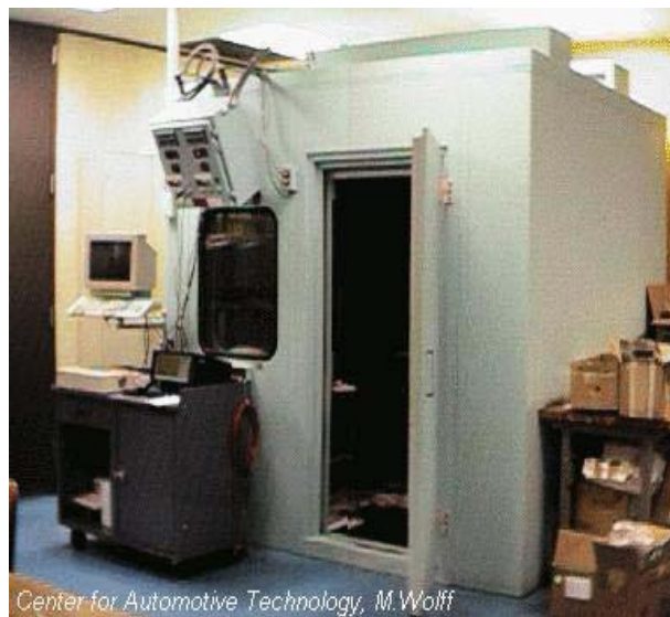
Figura 6.2 Máquina de Pruebas Funcionales (simula las condiciones de operación de un auto)
