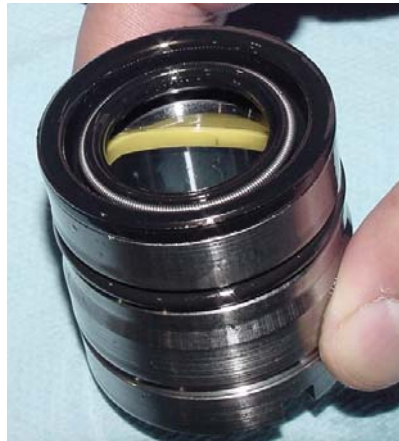
Figura 6.6 Ensamble de Buje-Sello encontrado en la dirección con fuga
