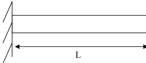
Fig. 12 Diagrama de Viga en Cantilever
